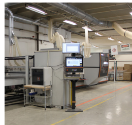
Platene overføres automatisk via kran fra lageret til maskinen.
